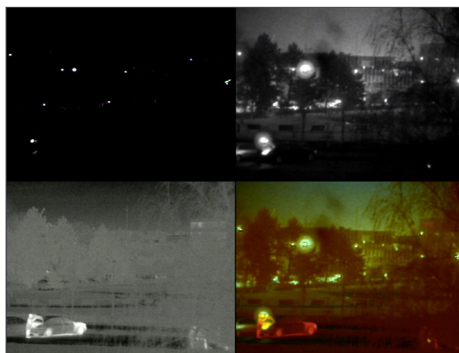
Obrázek 6 - fúze za tmy v MixPlayer (VIS CCD, VIS mikrokanálek, LWIR, fúze WaveletMax + Huang)
