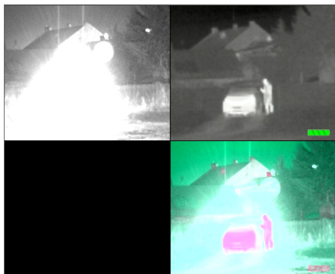
Obrázek 4 - fúze při oslnění v MixPlayer (VIS, LWIR, fúze Mara 2.5)
