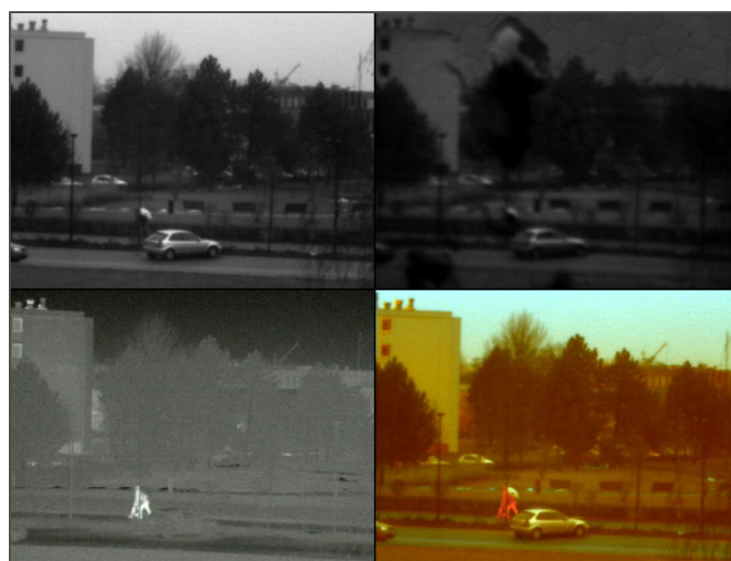
Obrázek 5 - fúze za světla v MixPlayer (VIS CCD, VIS mikrokanálek, LWIR, fúze WaveletMax + Huang)
