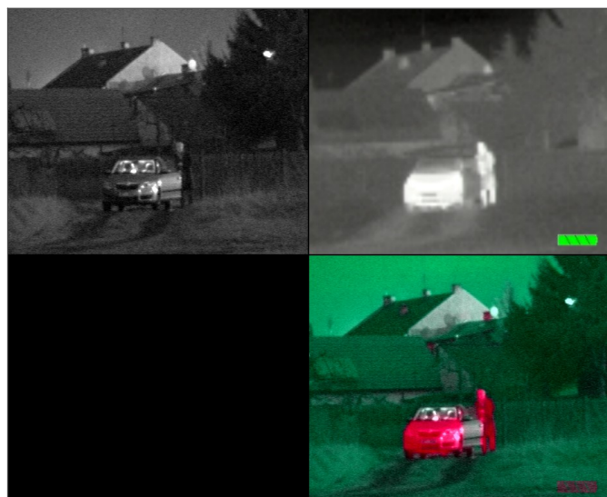
Obrázek 3 - fúze před oslněním v MixPlayer (VIS, LWIR, fúze Mara 2.5)
